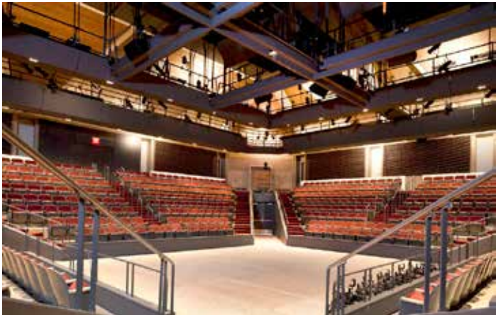
Nach der Renovierung: Die technische Decke wurde neu angeordnet und mit Öffnungen versehen, die Zugänge zur Bühne wurden erweitert
